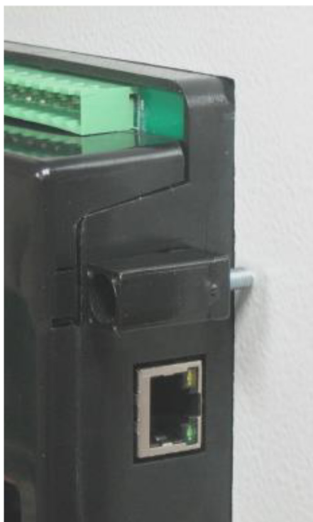
Установка винтового кронштейна
